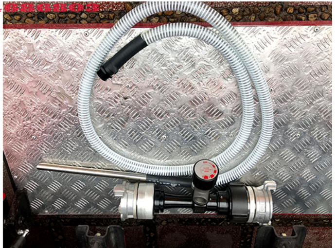
Ảnh: Bơm chữa cháy, cuộn vòi phản ứng nhanh, Lăng giá và Ejecter Foam trang bị trên xe
