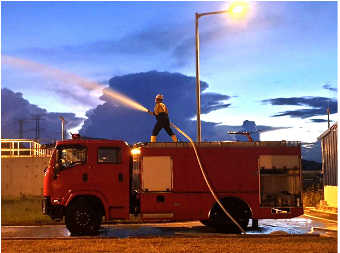
Ảnh: Ô tô chữa cháy 5,5 khối Isuzu tại nhà máy nhiệt điện NS2PC
