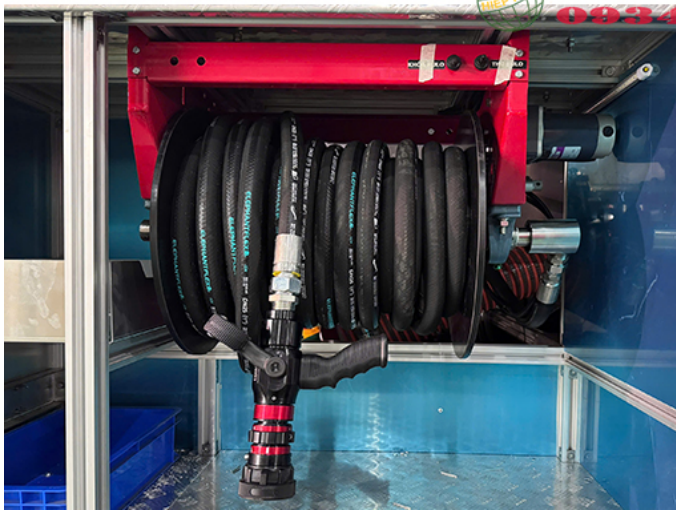
Ảnh: Bơm chữa cháy, cuộn vòi phản ứng nhanh, Lăng giá và Ejecter Foam trang bị trên xe
