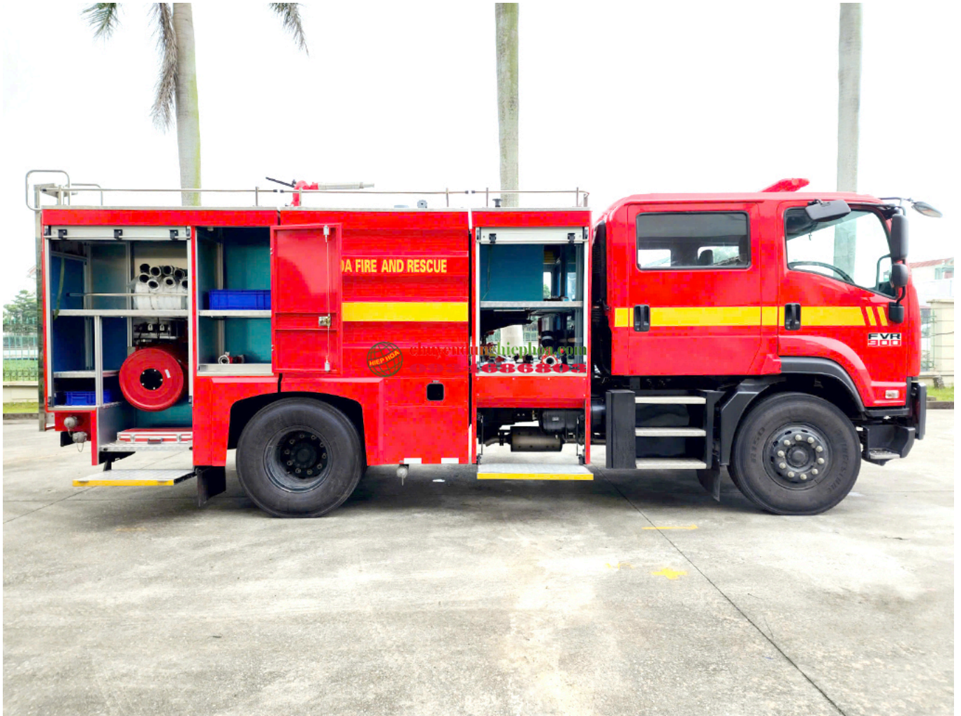
Ảnh bố trí khoang chứa đồ trên xe chữa cháy 5,5 khối Isuzu
