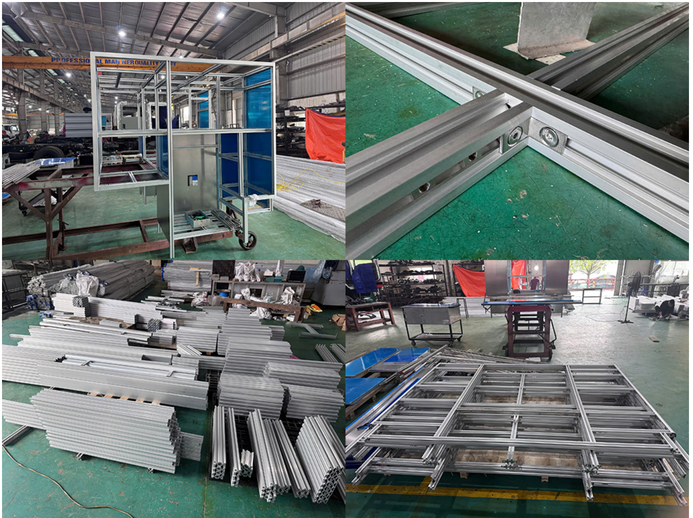
Ảnh: Nhôm thanh đúc định hình làm khung chịu lực xe chữa cháy
