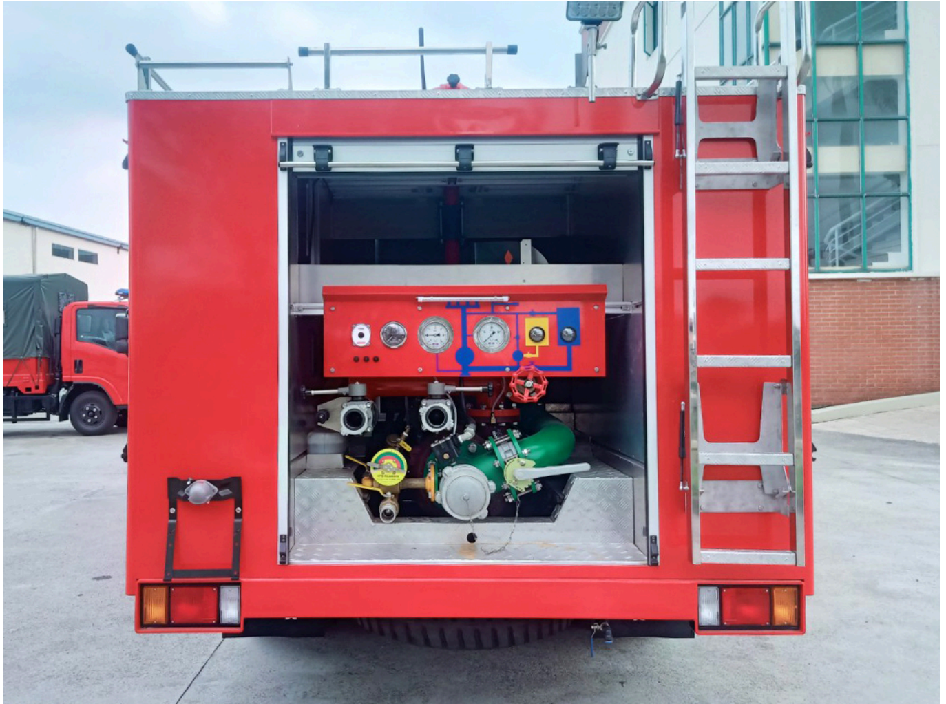
Ảnh khoang chứa bơm và bảng điều khiển trung tâm
