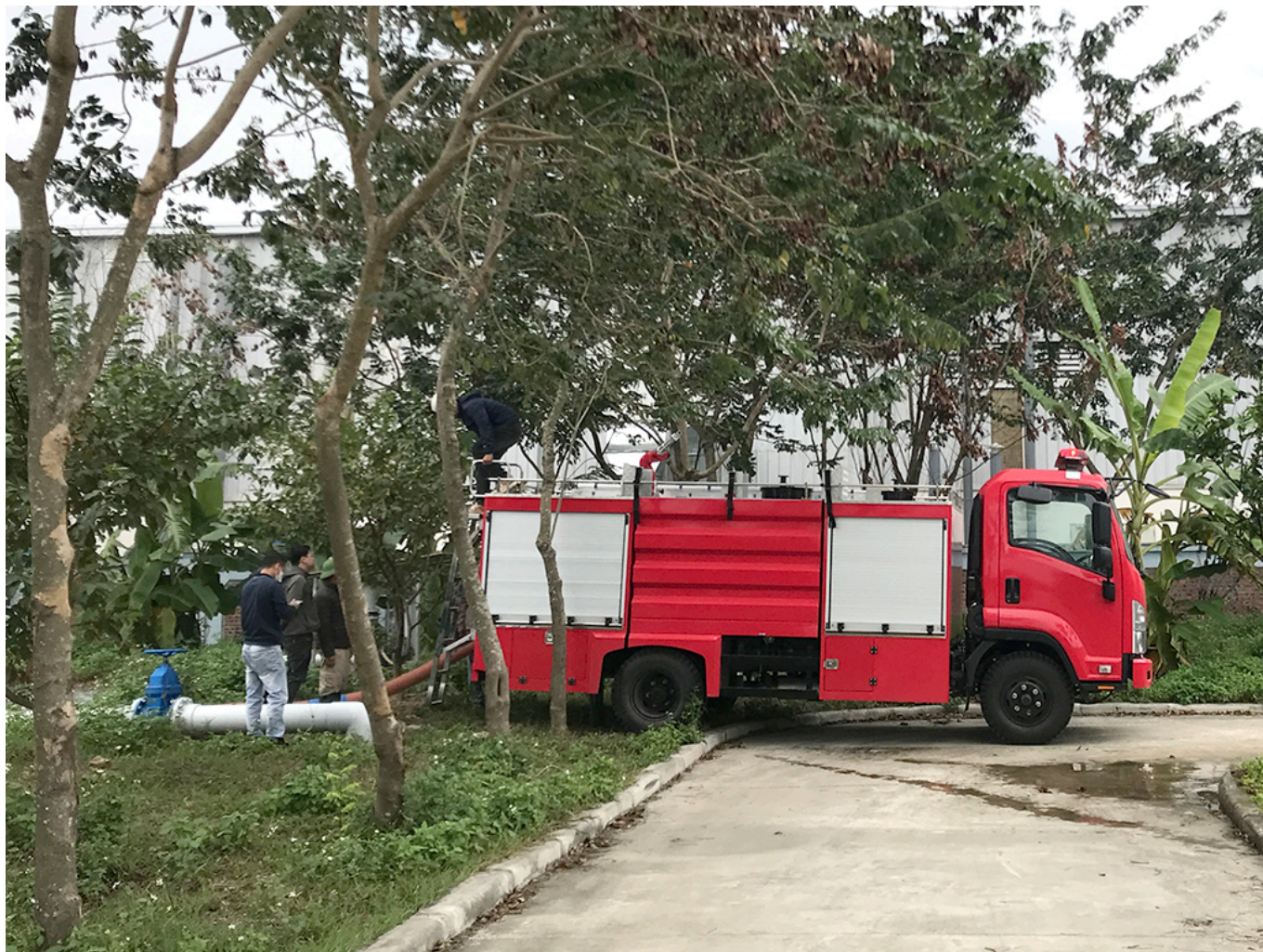
Ảnh: Xe chữa cháy đang lấy nước từ hồ chứa trong KCN
